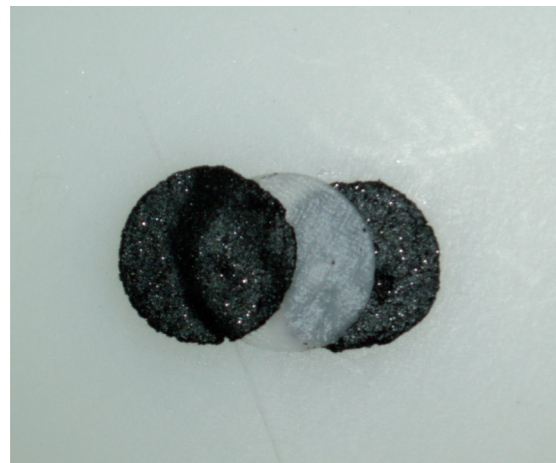
Vue éclatée d'un assemblage symétrique électrodes-séparateur d'un supercondensateur à base d'aérogels de carbone
